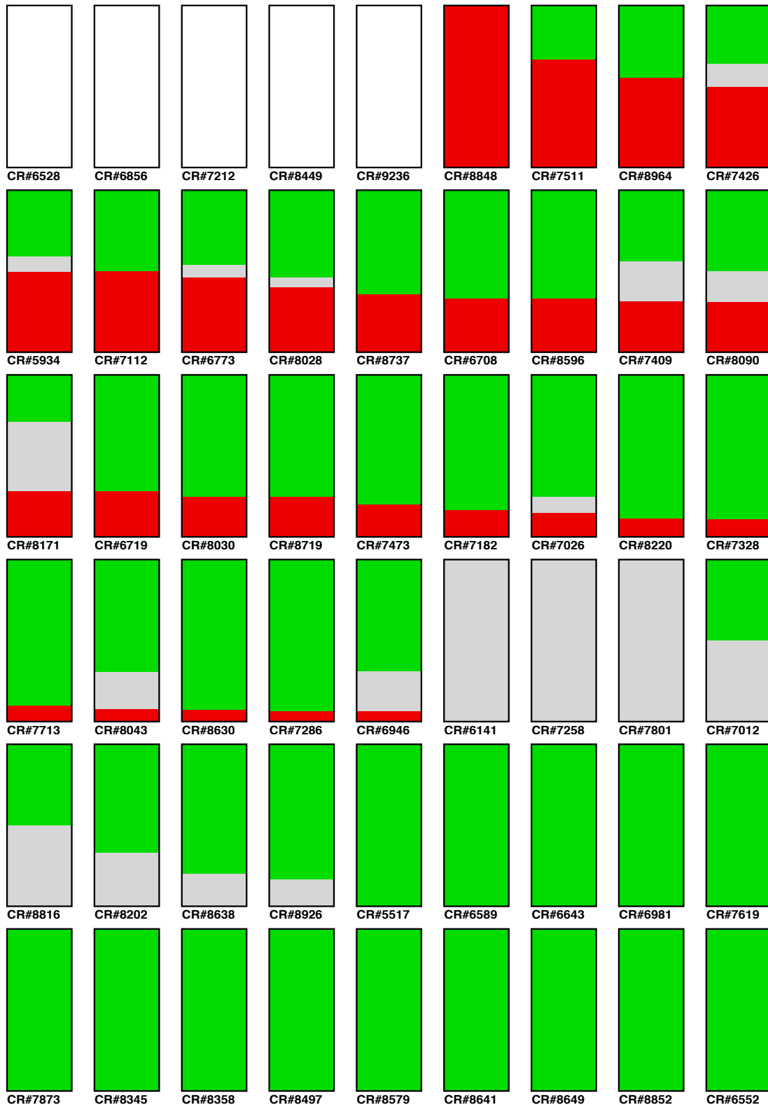
Abbildung 5.7: Jedes Rechteck steht für einen CR. In Farben sind die relative Anteile der Anzahl der Methoden des Changesets dargestellt, die im Testfall (grün) oder im Startprozedere (grau) ausgeführt bzw. nicht ausgeführt wurden (rot).
