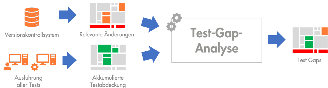
Abbildung 5. Ablauf der Test-Gap-Analyse (TGA). Für eine Menge von Änderungen identifiziert TGA diejenigen Änderungen, die noch nicht getestet wurden, also die Test-Gaps.
